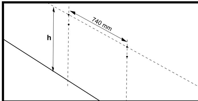
**2. Fixer les équerres** de fixation à l'aide de vis et chevilles (*non fournies*) adaptées à la nature du support.
