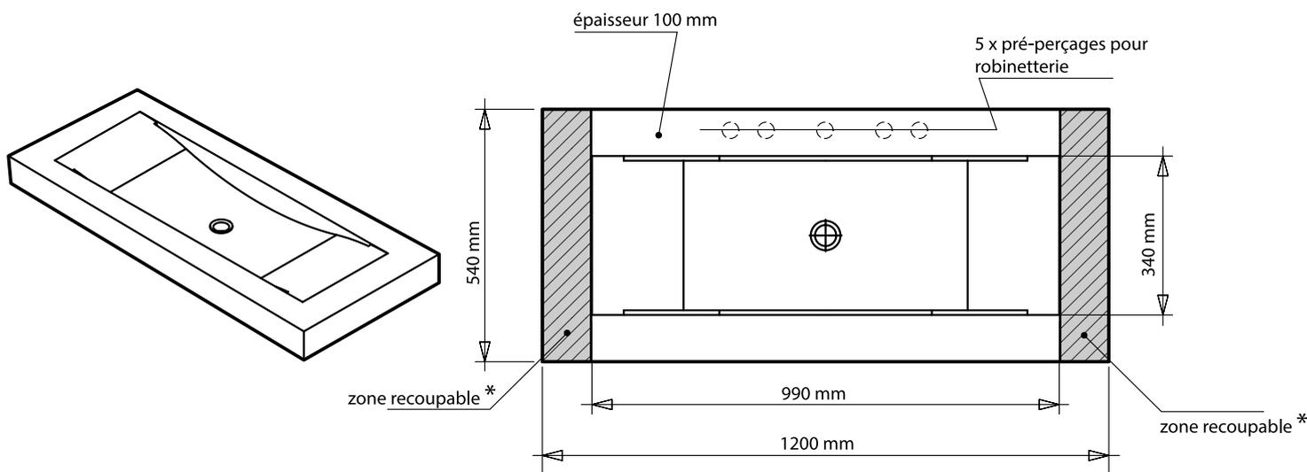
\* Ajuster si nécessaire la longueur du plan de vasque, les extrémités hachurées sur le dessin représentent les zones recoupables.
