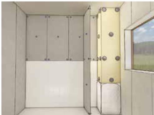
01. Appliquer sur le carrelage existant une couche de mortier colle gris de fixation Panodur à l'aide d'une taloche crantée de 8 mm. Percer dans le panneau 6 trous au m<sup>2</sup> en partie haute et disposer des plots de colle sur le panneau à l'emplacement des trous.
