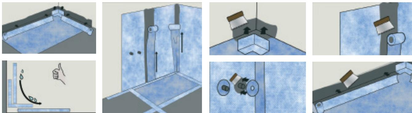
Les collerettes sont fournies pour le passage des tuyaux, garantissant ainsi une étanchéité optimale.
