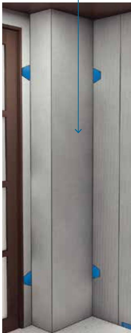
**01.** Positionner les fixations en parties haute et basse. Fixer le panneau à l'aide des fixations déportées pour coffre Panodur tout en encollant le champ de Panodur Coffre avec la cartouche de colle pour assemblage Panodur.
