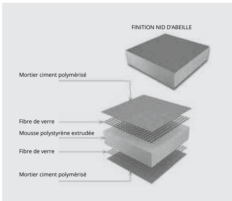
Les panneaux de construction PANODUR sont constitués d'un noyau en mousse polystyrène à cellule fermée qui possède des propriétés d'étanchéité et d'isolation importantes.
